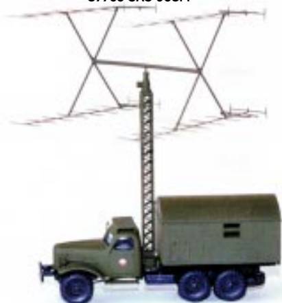
87116 Радиолокационная станция П-10 (ЗИЛ-157)
