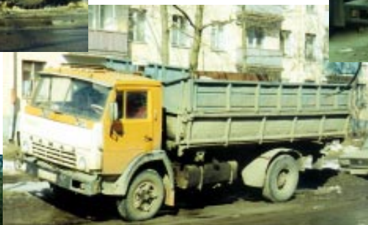
Еще один самосвал. Шасси двухосного КамАЗа с кузовом, предположительно от КамАЗ-55102
