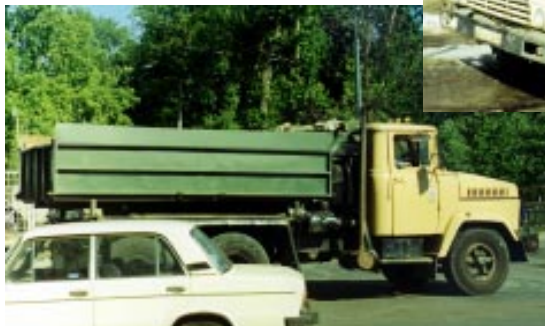
КраЗ-самосвал с двух(трех?)сторонней разгрузкой
