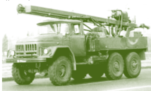
Автомобильная мастерская МС-А модели 49141 на шасси ЗиЛ-131Н. 1989
