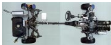
Рис. 60. Трансмиссия VW Passat Variant Syncro (1986)
