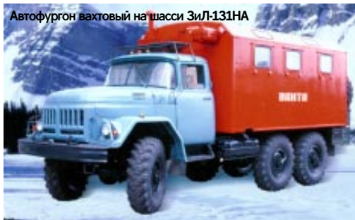
Автофургон вахтовый на шасси ЗиЛ-131НА
