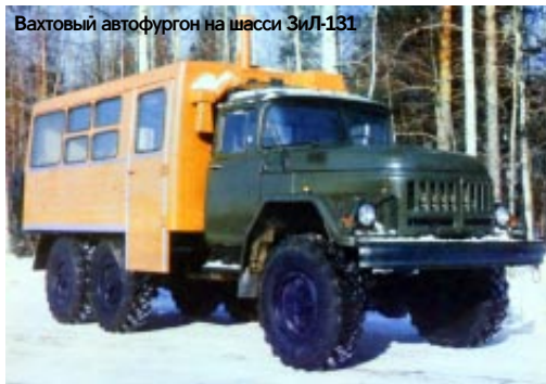
Вахтовый автофургон на шасси ЗиЛ-131
