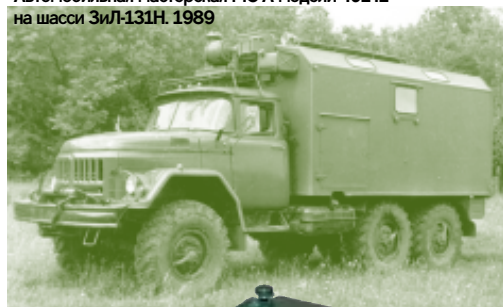
Автомобильная мастерская МС-А модели 49141 на шасси ЗиЛ-131Н. 1989
