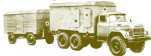
Дезинфекционно-душевая установка ДДА-3 в составе автопоезда
