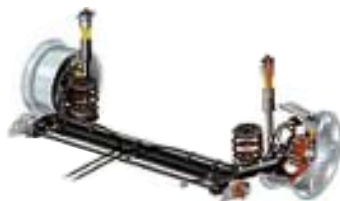
Рис. 112. Задняя подвеска Volkswagen Passat пятого поколения (1996)
