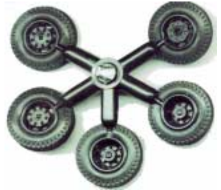
Комплект колёс для ЗИС-164 (ранний ЗИЛ-130): 5 дисков (полистирол) — 2 передних, 2 задних и «запаска» без болтов; 7 шин (вулканизированная резина) (Модельная группа «Днепр»)
