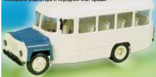
КАвЗ-3270 (Компаньон). Изменённые по сравнению с КАвЗ-685 облицовка радиатора и передний скат крыши
