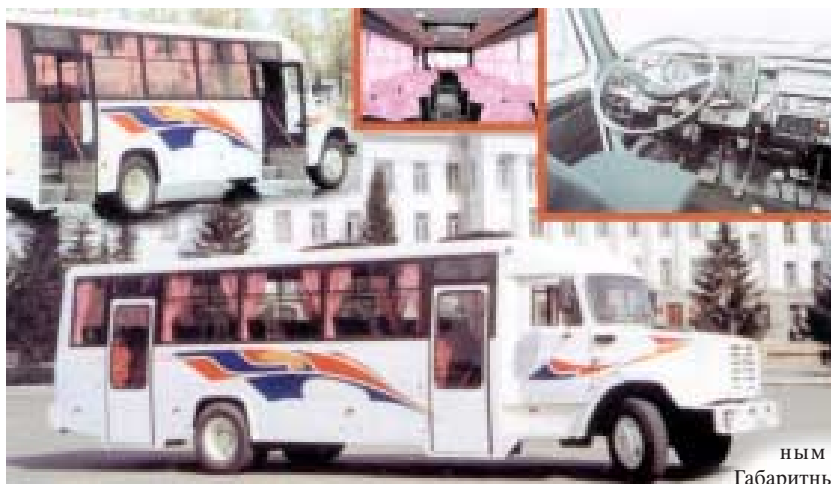
Габаритные размеры машины – 9163x2500x3100 мм, колёсная база – 4680 мм.
