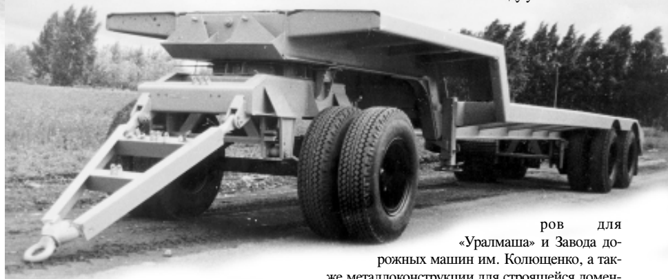
Полуприцеп-тяжеловоз ЧМЗАП-93853 с подкатной тележкой ЧМЗАП-8379
