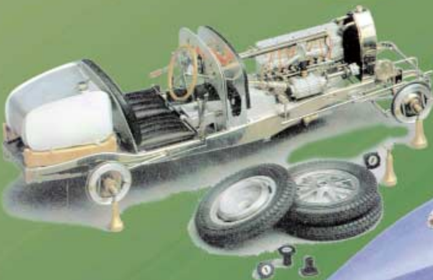
Шасси модели Bugatti 35B. У модели работают механизм поворота руля и механические тормоза
