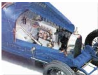
1,5-литровый 4-цилиндровый рядный двигатель Bugatti 37 (1926 г.)
