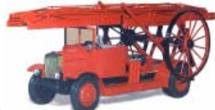
Пожарный автомобиль с механической лестницей METZ на шасси Я-3 (Волчанецкий, Запорожье)
