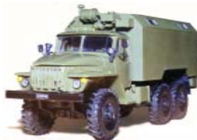
К-1.4320, фургон армейский на шасси Урал-4320 (ВИКО-моделс с использованием моделей Электон)
